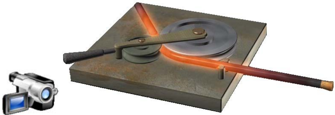
Fig.8.4.1.11.Îndoirea țevelor la cald
