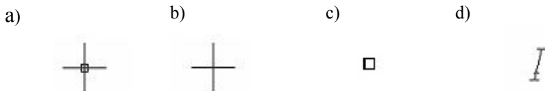
Fig. 1.12. Aspectul cursorului: a) cursor; b) colimator; c) selector; d) indicator de text
